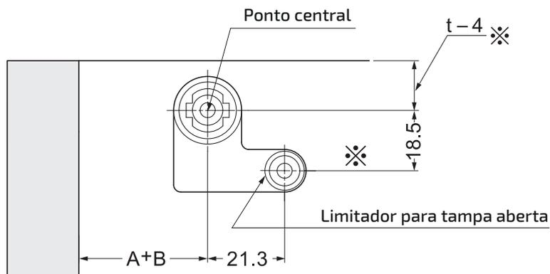
✖ Dimensões dadas quando a parte superior da tampa e o painel lateral mimetizam
