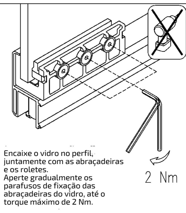
Encaixe o vidro no perfil, juntamente com as abraçadeiras e os roletes. Aperte gradualmente os parafusos de fixação das abraçadeiras do vidro, até o torque máximo de 2 Nm.
