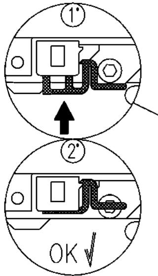
Posicione a porta e encaixe o perfil inferior no guia inferior.
