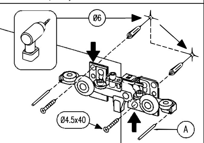
Perfure a parede e instale as 2 buchas. Parafuse o trilho com os pinos instalados na parede (A).
