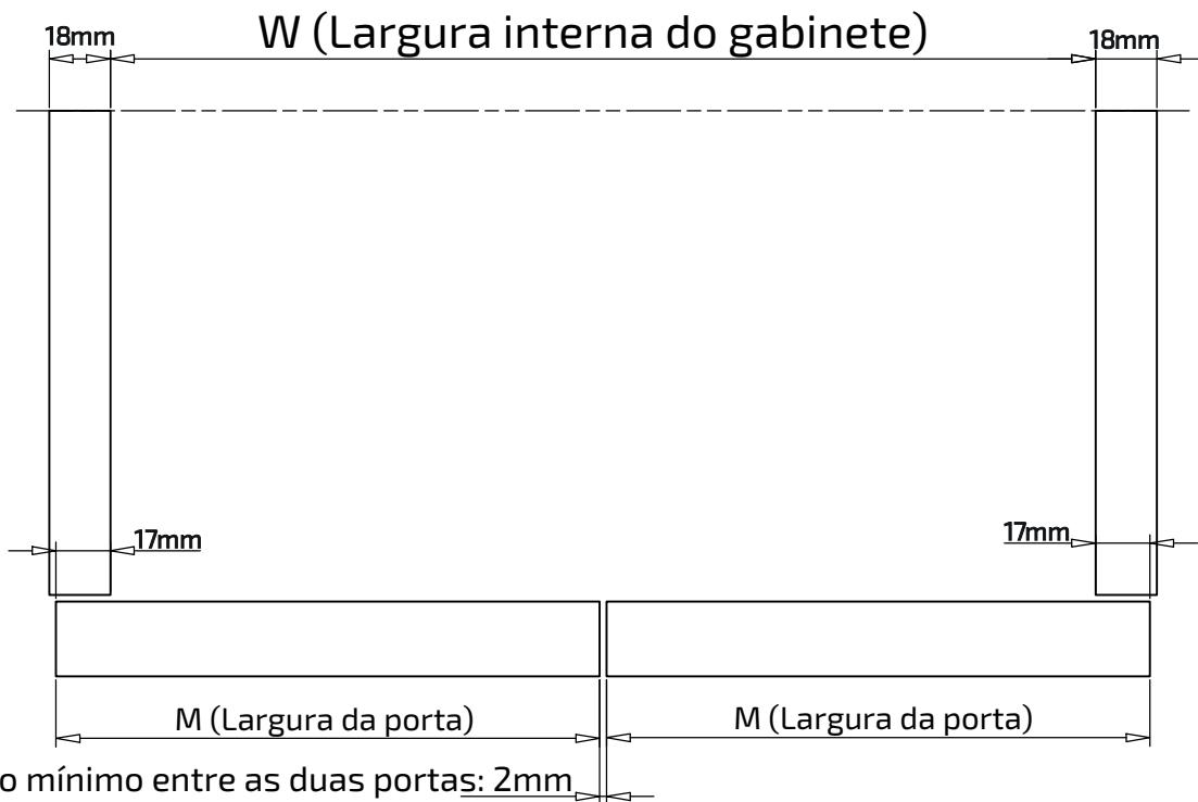
$$\text{Largura da porta } M = W/2 + 16 \text{ (quando a espessura do painel lateral for 18mm)}$$
