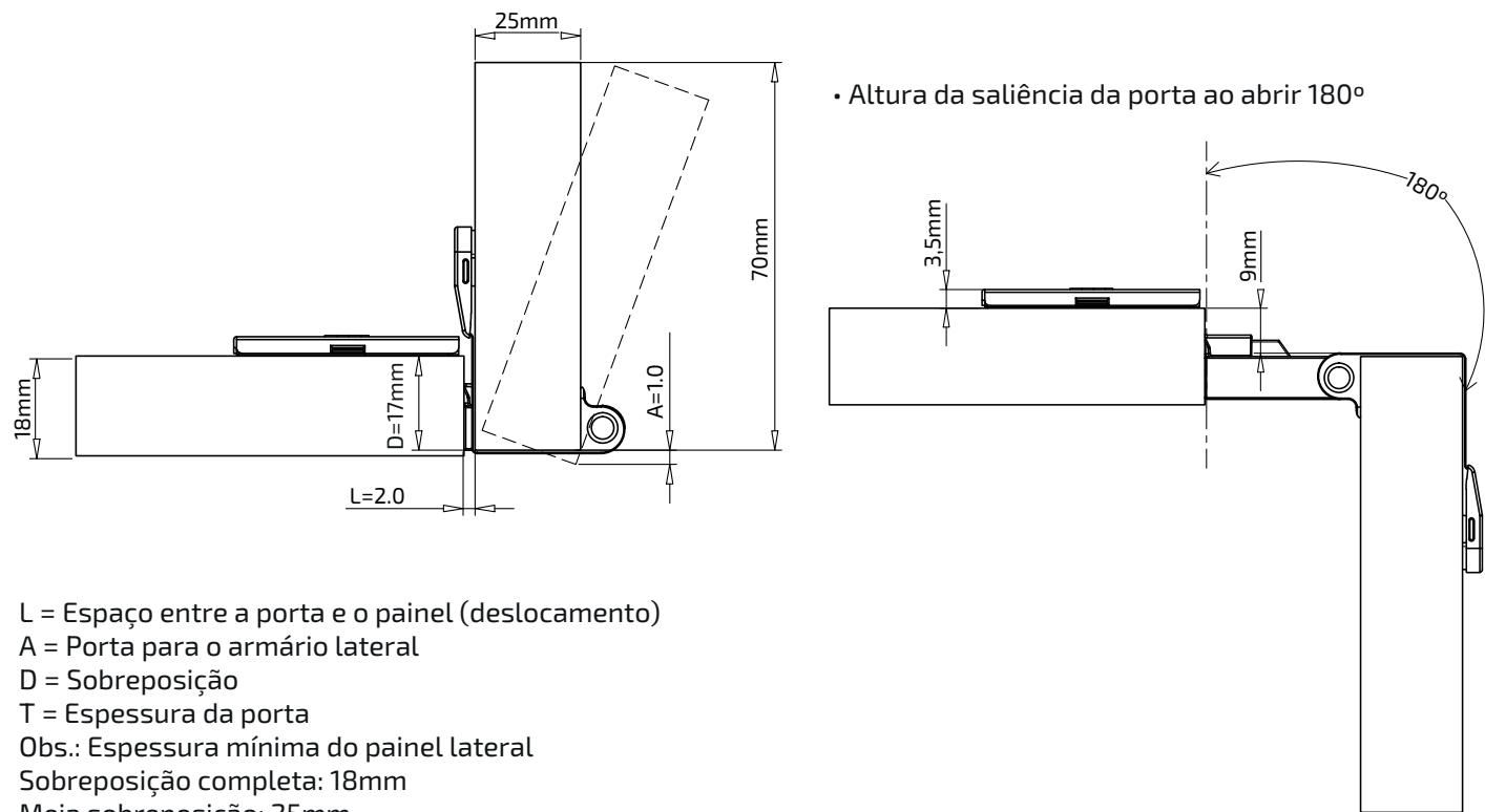
Usinagem do painel lateral: Sobreposição completa
